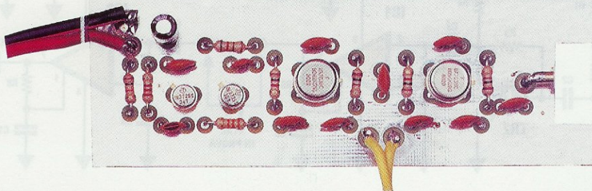
Fig.10 Il piccolo circuito stampato siglato CS.1552 è un doppia faccia con i fori metallizzati. Lo strato di rame prestagnato, visibile sulla parte superiore del circuito, serve da schermo per le piste presenti sulla superficie inferiore. Sul circuito stampato che invieremo assieme al kit, troverete riportato un disegno serigrafico completo di sigle dei singoli componenti e della vernice antiossidante depositata su entrambi i lati.
